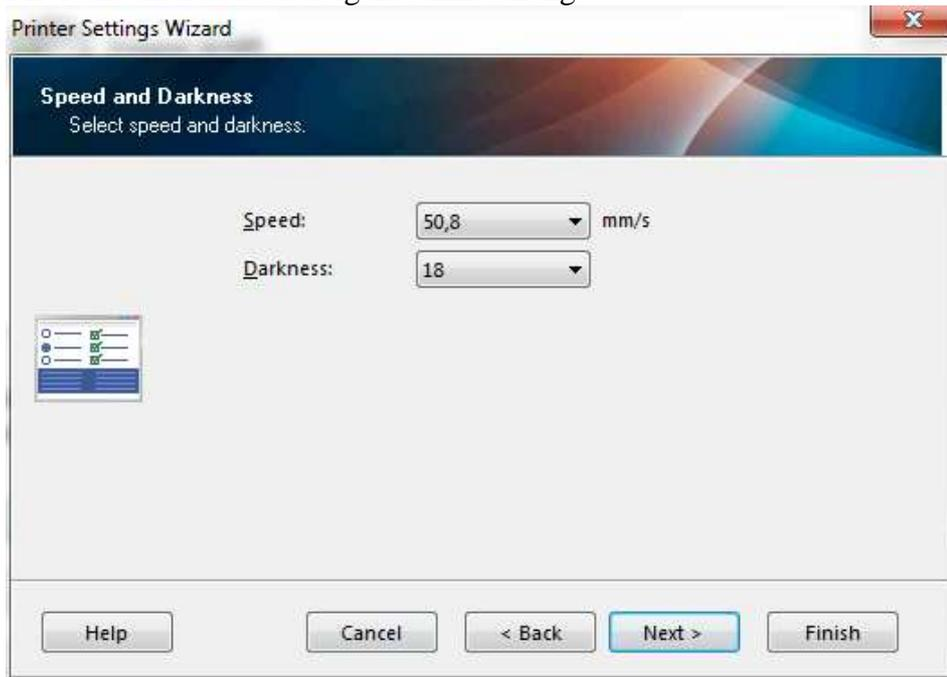
Reduzieren Sie die Geschwindigkeit/Speed etwas (z.B. 50,8 mm/s) und erhöhen Sie die Darkness leicht (18) um die Druckqualität zu verbessern.
